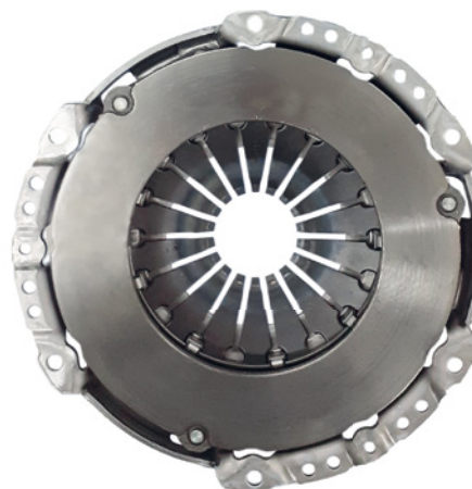
Figuur 1: Drukplaat 122 0395 10 met groot wrijvingsoppervlak diameter 220 mm
